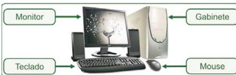
Figura A4. Principais partes que compõem um computador. (Fonte: ver lista de créditos de imagens 02).
