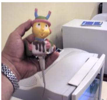
Figura 11 – Microfone com brinquedo de pressão acoplado
