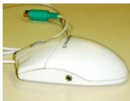
Figura 13 – Mouse adaptado com *plug*
