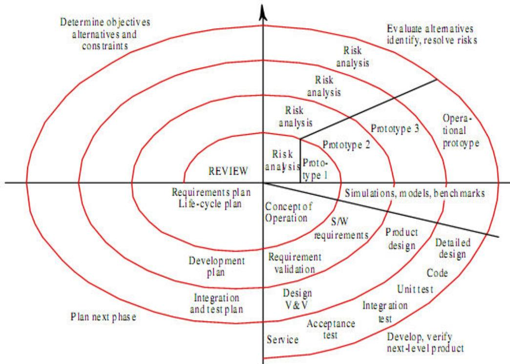
**Figura 10: Modelo da Espiral detalhado.**
