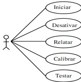
**Figura 11: Diagrama de casos de uso do subsistema estação meteorológica**
