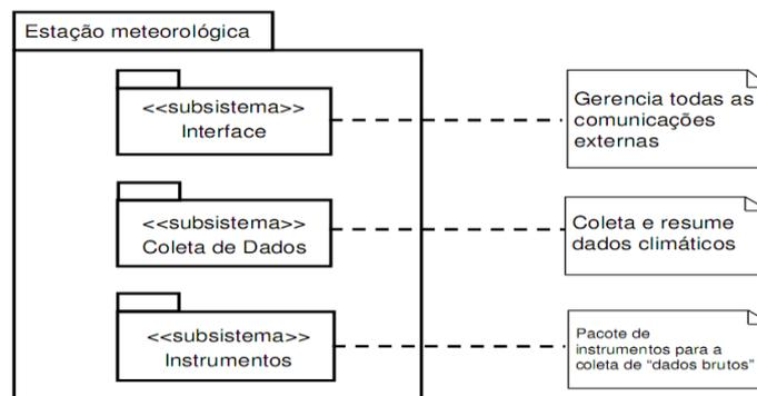
**Figura 10: Os subsistemas da estação meteorológica**
