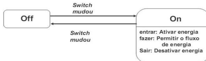
**Figura 13: Diagrama de estados associado ao switch (interruptor).**
