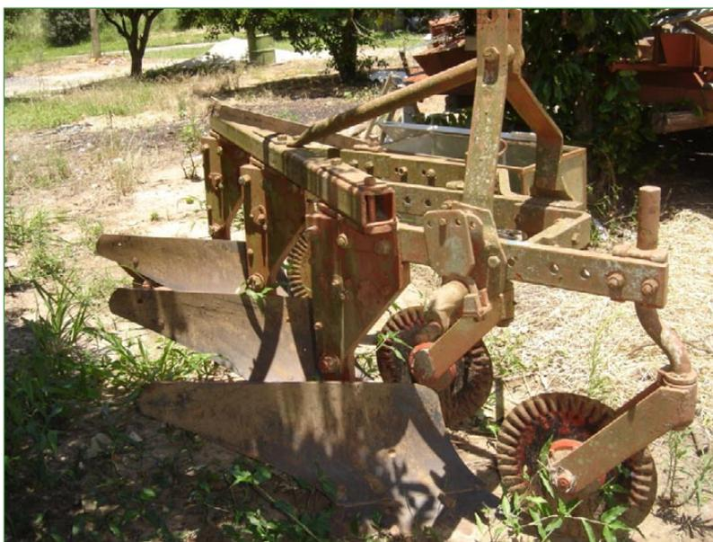
Figura 4.5 – Arado de aivecas de tração mecanizada (Foto: A. Doneda, 2009).
