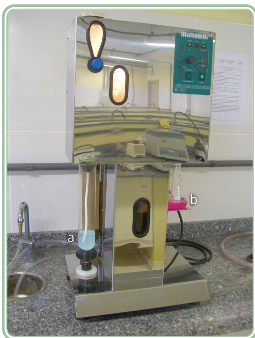
Figura 5.8: Destilado de nitrogênio contendo tubo de digestão (com líquido azul – a) e erlenmeyer contendo ácido sulfúrico (com líquido vermelho – b)
