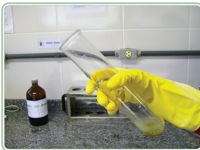
Figura 5.7: Tubo de digestão contendo amostra, mistura catalítica e ácido sulfúrico
